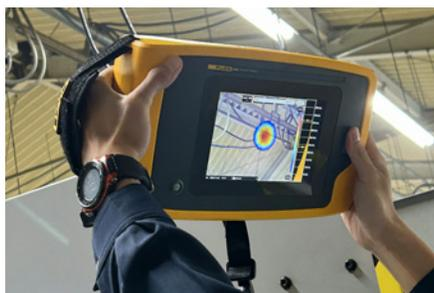
当社では、工場別・設備別に電気使用量の把握をし、日々の改善活動へと繋げています。LED照明の切り替え、空調の適温化、インバータ付きのコンプレッサーへの変換、パルスブローへの変換など、様々な活動を進めています。設備の稼働時間削減のため、段取り時間の削減やサイクルタイム向上などの活動も積極的にしています。また、エア漏れ箇所を可視化できる装置を使用し、普段では見えない箇所のエア漏れを発見し迅速に改善へと繋げています。
